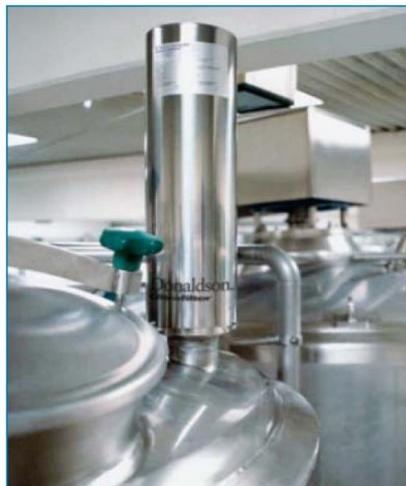
Все компоненты фильтроэлемента (P)-BE соответствуют требованиям FDA для контактов с пищевыми продуктами в соответствии с CFR, Разделом 21.
